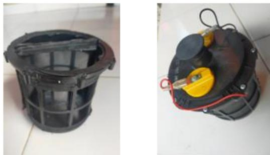
Gambar 6. Tabung reaktor untuk sel baterai air garam
